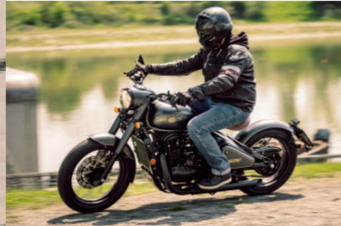
Lässige Silhouette, die die Wahrnehmung in die Irre führt: Nicht der Sattel schwingt, sondern die vermeintlich starre Schwinge; und die dünnen Auspuffröhren verfügen über einen versteckten Sammler unter dem Motor.
