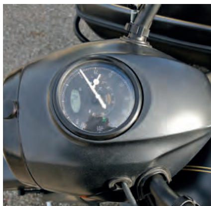
Originell: Die kompakte Tacho-Einheit bietet gleich zwei km/h-Skalen.
