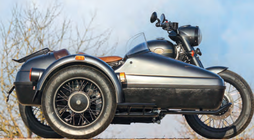
Probate Basis: Der Rahmen der Perak erlaubt einen unkomplizierten Bootsanschluss.
