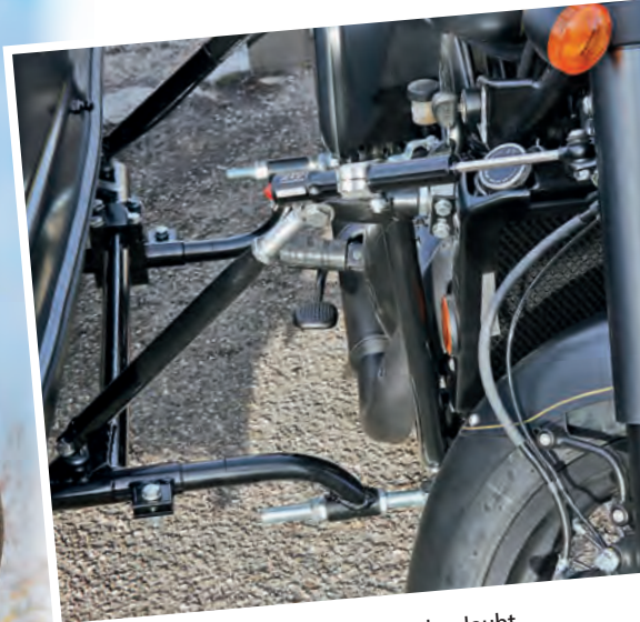
Probate Basis: Der Rahmen der Perak erlaubt einen unkomplizierten Bootsanschluss.
