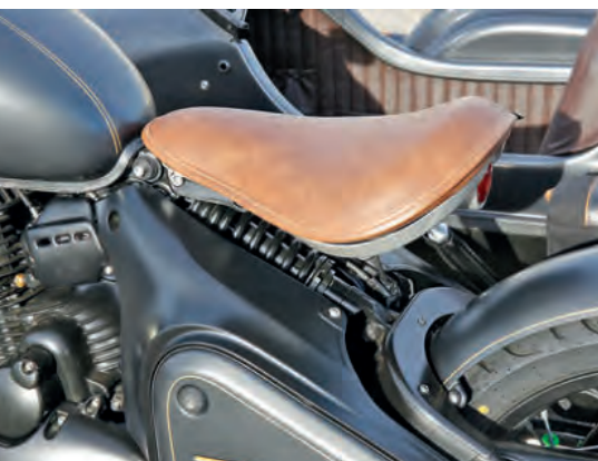
Gut zugänglich: Der Gasdruckdämpfer lässt sich siebenfach verstellen.
